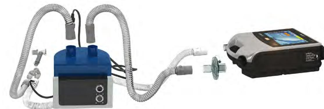
Ao usar umidificação aquecida com circuito de ramo duplo, pode haver formação de condensação no sensor de fluxo expiratório se o ar for resfriado em temperatura abaixo do ponto de condensação. Também pode haver formação de condensação no circuito do paciente, o que é mais provável com configuração de umidade alta e temperatura ambiente baixa.
