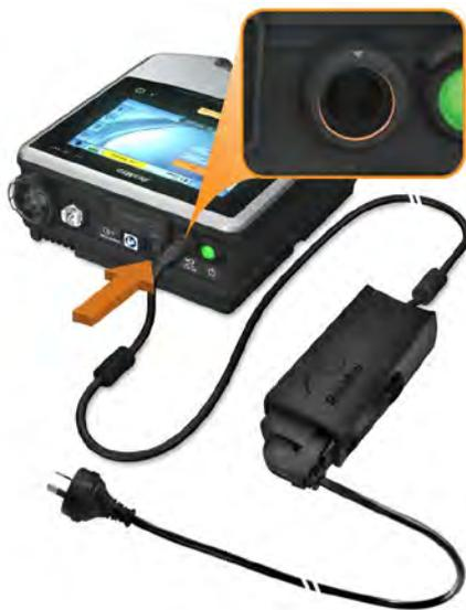
**Observação:** O cabo elétrico está equipado com um conector de bloqueio de pressão. Para remover, segurar no revestimento do cabo elétrico e puxar suavemente o conector do dispositivo. Não torcer o revestimento externo nem puxar pelo cabo.
