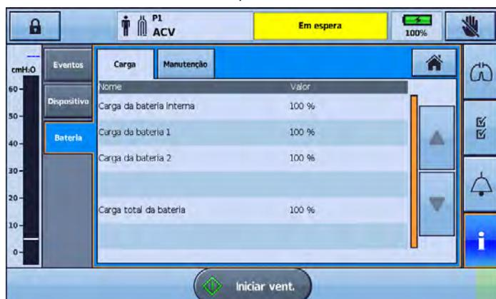
Verifique regularmente o nível de carga da bateria interna e quaisquer baterias externas conectadas. Recomenda-se trocar as baterias em 400 ciclos de carga.
