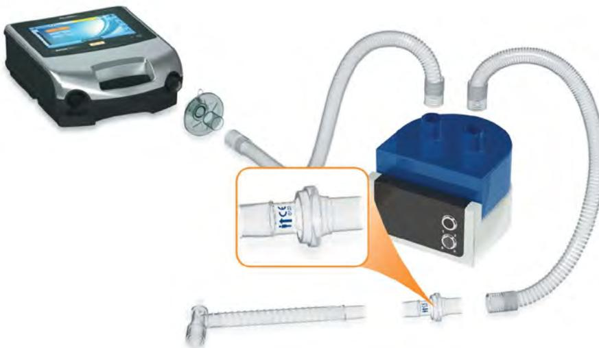
Para a ventilação invasiva, como é feito um “bypass” (desvio) do sistema respiratório superior do paciente usando-se um dispositivo artificial de vias aéreas (por exemplo, um tubo endotraqueal ou um tubo de traqueostomia), é necessário umidificar o gás inspirado para prevenir lesões pulmonares.
