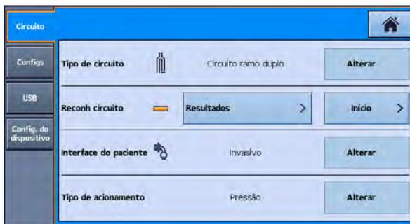
**Observação:** O tipo de acionamento define se um limiar de acionamento à base de pressão ou à base de fluxo será utilizado quando um circuito duplo é selecionado.
